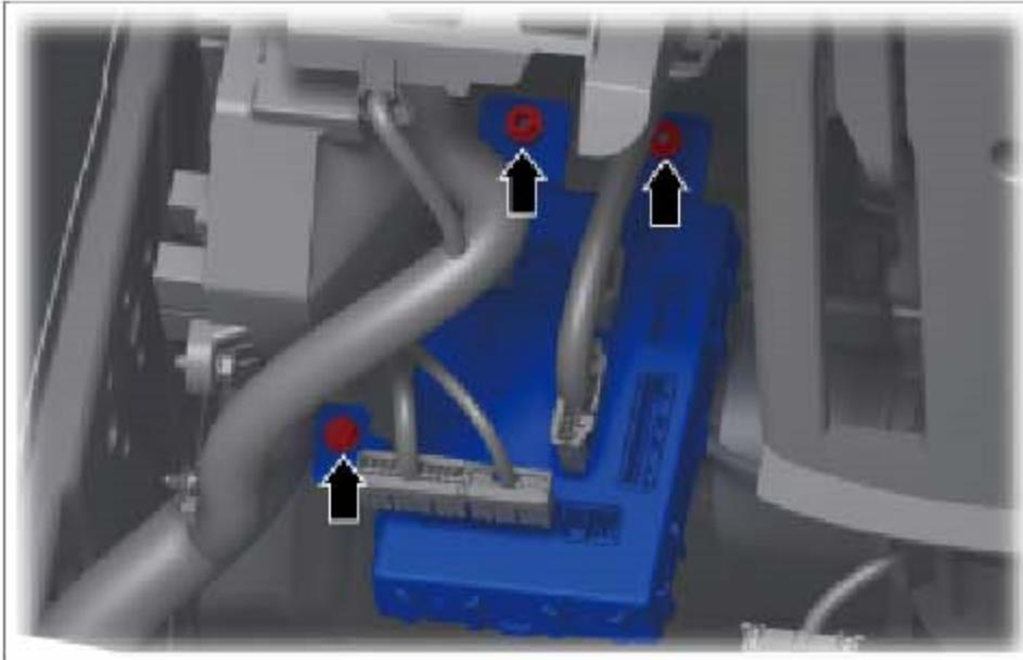
安装 BCM，安装 2 个固定螺母和螺栓。
