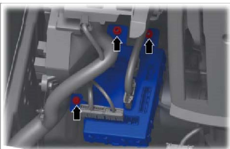
拆下 BCM 2 个固定螺母和螺栓,并拆下 BCM 。
